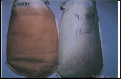
4-3 Boru hattı filtresi. Kırmızı pas solda. Dört ay sonraki hali sağda.
